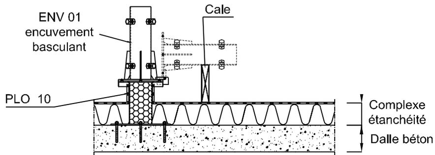
④ - Mise en oeuvre de l'encuvement basculant ENV01 par boulonnage sur le plot PLO 10 .
