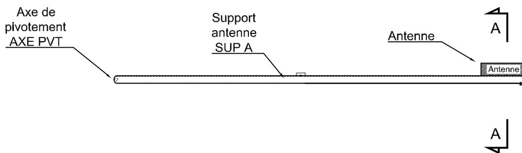
③ Montage de l'antenne sur le support SUP A.
